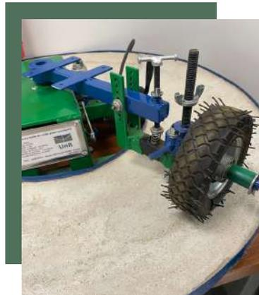
Análise de ruído do contato pneu-pavimento
